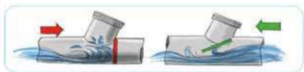
Principe de fonctionnement d'un clapet anti-retour
