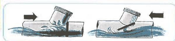
Principe de fonctionnement d'un clapet anti-retour
